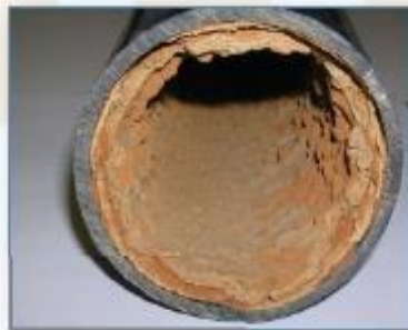
Pérdida de sección debida a la acumulación de cal
