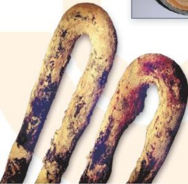
Pérdida de sección debida a la acumulación de cal
